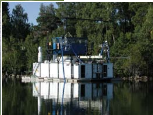
Vattenresurs vill behandla vatten och sediment nära botten med aluminiumklorid för att binda fosfor och förhindra denna att delta i övergödningen.
